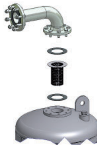
Demontáž prachového sitka
